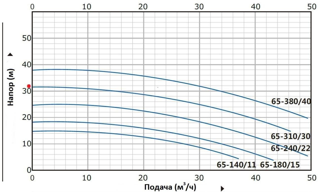
Пояснение к графикам: Напор (м) – напор в метрах водяного столба, Подача (м³/ч) – подача в метрах³ в час, Измерения проводились для чистой воды, температурой 20°C и вязкостью 1 мм²/с
